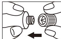
●キャップを逆さにして、突起部をチューブの先に強く押し当ててください。
